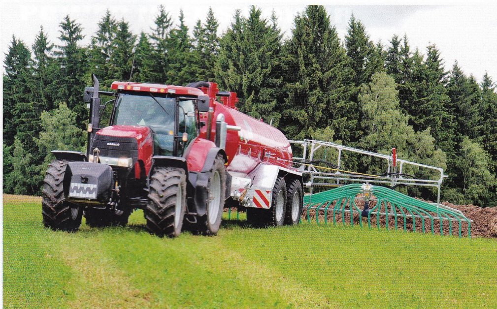
► Cisterna Wienhoff v barvách techniky Case IH má snížené těžiště, což je podmínkou pro práci v kopcovitém terénu
