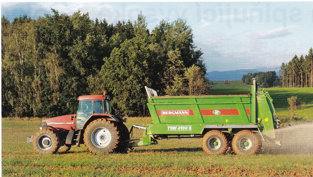
► Rozmetadlo Bergmann TSW 4190 S umožňuje kvalitní rozmetání dolomitického vápence...
